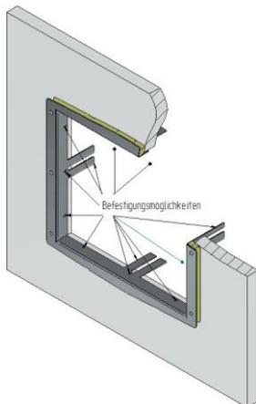
mittels Schrauben Rahmen wahlweise an Haltetaschen oder durch die Löcher in der umlaufenden Abkantung an der Revisionsaussparung befestigen
