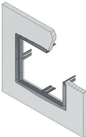
Rahmen der SW montieren, dazu den Rahmen bis an die Wandoberfläche des Revisionsausschnitts schieben, gerade
