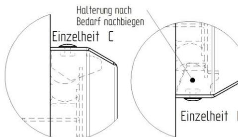
Abdeckung unten ansetzen, nach oben drücken und oben an die Wand drücken, zum Lösen Abdeckung nach oben schieben und oben von der Wand abziehen (*nach Bedarf Halterung unten nachbiegen*)
