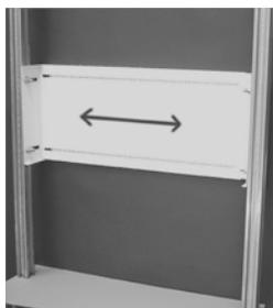
1. Montageriegel nach benötigtem Maß ausziehen (min. 490mm, max. 900mm) und wahlweise horizontal oder vertikal montieren
