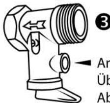
Anschluß für Überdruck-Ablauchschlauch
