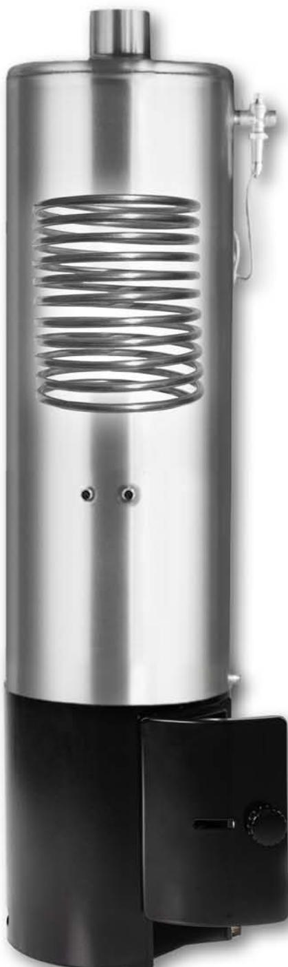
Der integrierte Wärmetauscher ermöglicht die Unterstützung der Warmwasserbereitung durch externe Wärmequellen. Er kann direkt an bestehende Wasserleitungen angeschlossen werden. Der Wärmespeicher kann als Solarspeicher verwendet werden. Wahlweise ist der ZW100 als stationärer Badeofen oder als Warmwasserboiler für andere Zapfstellen nutzbar. Der ZW100 lässt sich mit festen Brennstoffen befeuern.
